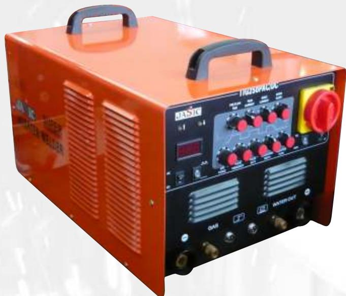
Este novedoso rectificador inverter, no solo permite trabajos sobre piezas de acero al carbono, aceros inoxidable, sino que también debido al selector de corriente alterna, permite efectuar trabajos sobre piezas de aluminio. Con pulsado electrónico de la frecuencia y posibilidad de seleccionar la corriente de base de la misma.
